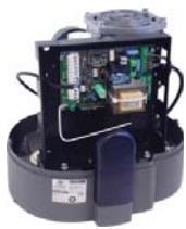
**BIG 0.8** è un motoriduttore elettromeccanico irreversibile 230 Vac per cancelli scorrevoli fino a 1000 kg di peso. Centralina ERMES incorporata con ricevitore radio. Regolazione di coppia elettronico, rallentamenti in apertura e chiusura regolabili, gestione indipendente della corsa d'apertura e di chiusura.
