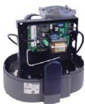
**BIG 2.2** è un motoriduttore elettromeccanico irreversibile 230 Vac per cancelli scorrevoli fino a 2200 kg di peso. Centralina ERMES incorporata con ricevitore radio. Regolazione di coppia elettronico, rallentamenti in apertura e chiusura regolabili, gestione indipendente della corsa d'apertura e di chiusura.
